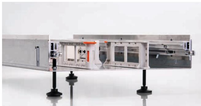
Le principe du triple compartiment assure un rangement parfaitement ordonné. Les deux compartiments extérieurs sont conçus pour le cheminement des câbles. Le compartiment central permet de brancher ou de débrancher les câbles d'alimentation ou de données. À partir d'une largeur de 400 mm, les canaux sont asymétriques afin de pouvoir abriter également un grand nombre de câbles de données.
